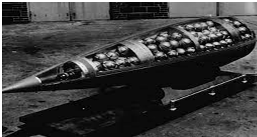
Şəkil 46. Diyircəkli aviasiya bombası
