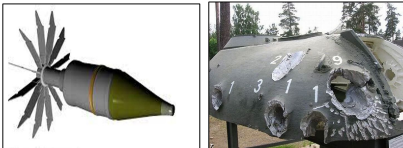
Şəkil 48. Kumulyativ artilleriya mərmisi (solda) və mərmnin yaratdığı fəsad (sağda)
